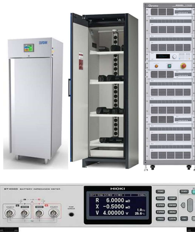
Figura 4 da sinistra a destra: camera climatica FDM T370s, sistema stoccaggio batterie ASECOS Type 90 e rack con ciclatori per celle e per moduli batterie CHROMA 17010/17020, in basso un analizzatore di impedenza Hioki per celle analogo a quello oggetto delle procedure di acquisto
