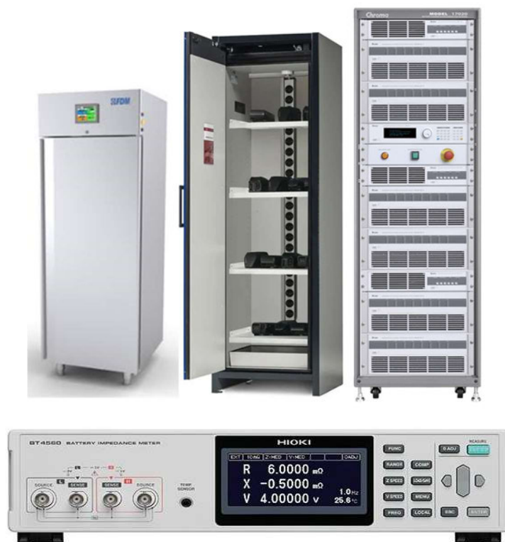
Figura 4 da sinistra a destra: camera climatica FDM T370s, sistema stoccaggio batterie ASECOS Type 90 e rack con ciclatori per celle e per moduli batterie CHROMA 17010/17020, in basso un analizzatore di impedenza Hioki per celle analogo a quello oggetto delle procedure di acquisto
